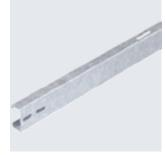
Trägerprofil zum Montieren von Photovoltaik-Modulen auf Freiflächensystemen. Montage des Trägerprofils auf vormontierten Trägern mit Kreuzverbinder KV FT. Montage der PV-Module am Trägerprofil mit End- und/oder Zwischenklemmen. Verbindung mehrerer Trägerprofile mit Längsverbinder LV FT oder Kreuzverbinder KV FT, schraubbar.
